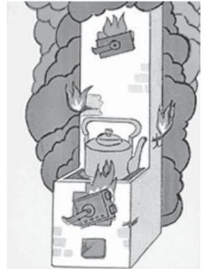
ние на наличие противопожарных разделок между печью и деревянными перегородками, стенами, а также в местах прохождения дымовой трубы через чердачное и междуэтажное помещение. В этих местах делают утолщения кладки трубы, а между стенами печи и перегородкой прокладывают кирпич, не связывая его с кладкой печи. Минимальная противопожарная разделка должна составлять не менее 38 см.
