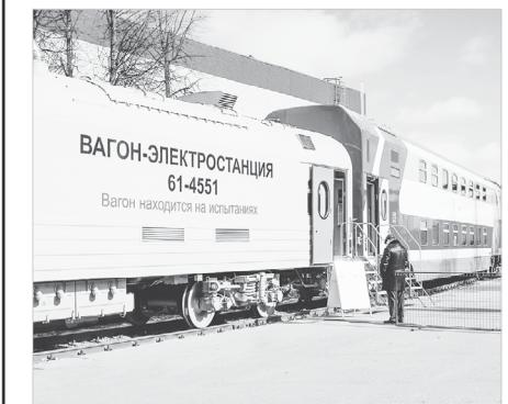
Новое оборудование может работать при температурах от -50 до +45 градусов при относительной влажности до 90%.
